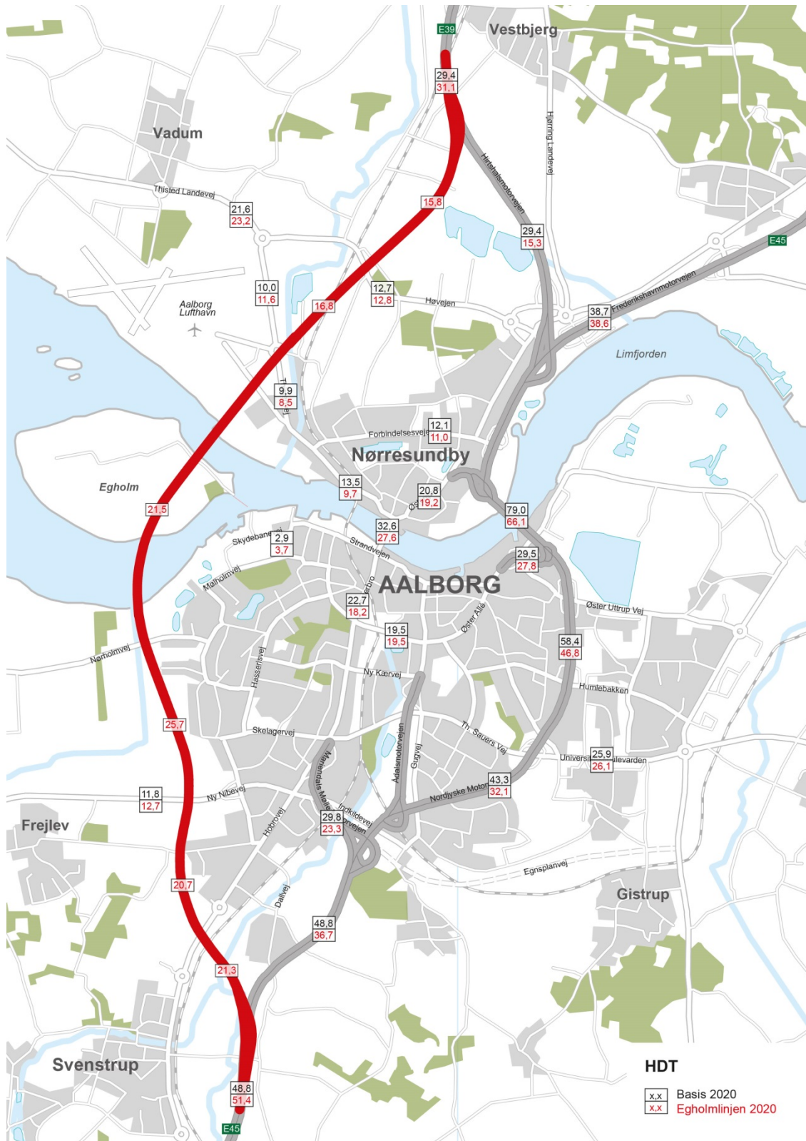
Figur 5. Trafikbelastning i hverdagsdøgntrafik 2020 på Basis (sort) og Egholmlinjen (rød) beregnet med LTM
